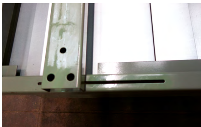
Distancia entre las vigas de apoyo regulable
